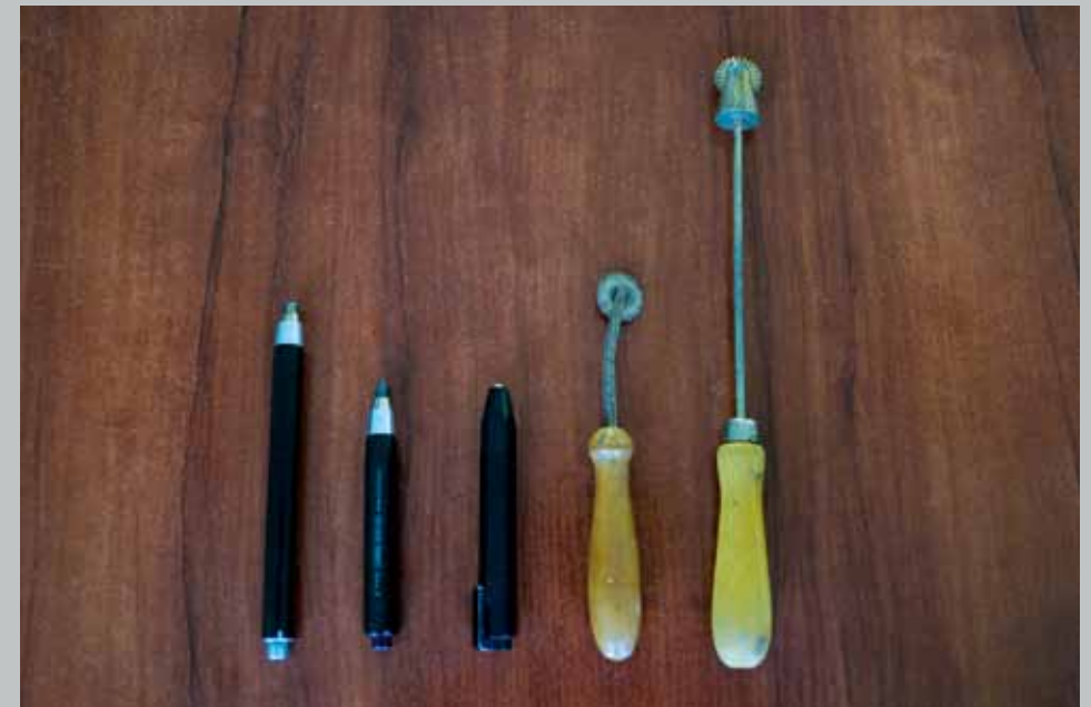
2. Narzędzia do przenoszenia rysunku na tynk (radelka i ołówki, tzw. kubusie). Fot. S. Tarasewicz
