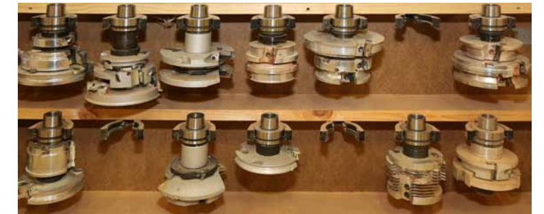
Frezy wielotarczowe użyte przy odtwarzaniu brakujących elementów.
