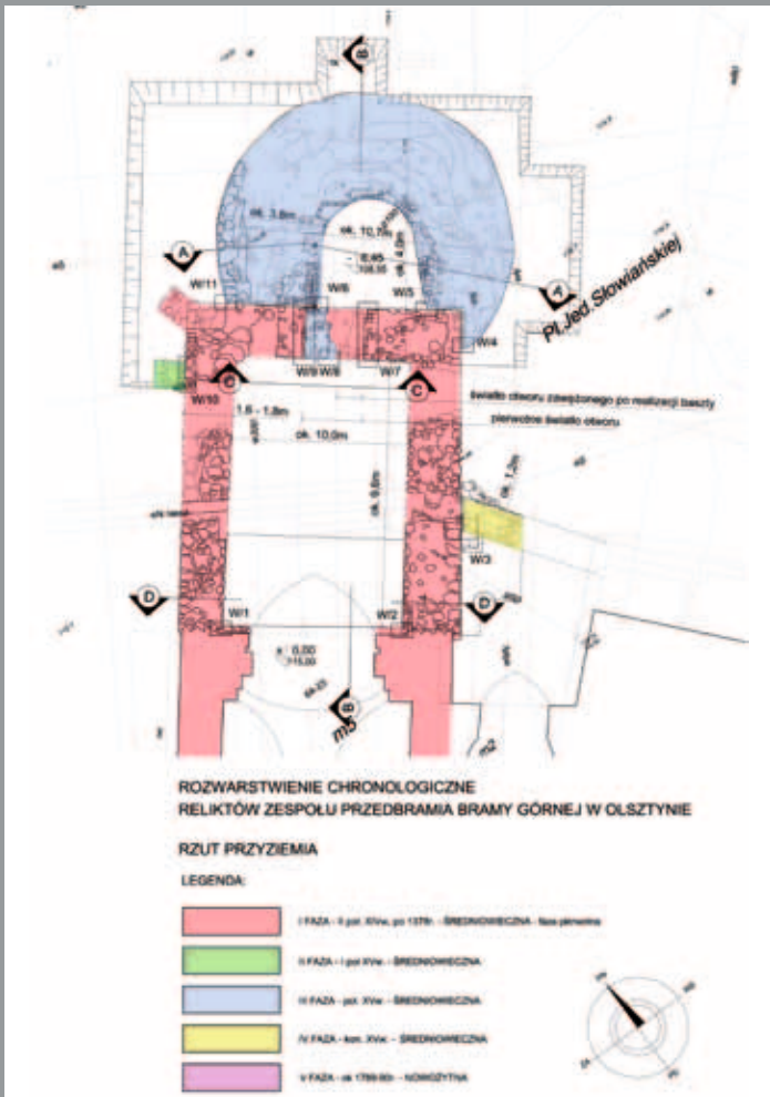
13. Rozwarstwienie chronologiczne reliktyw zespołu przedbramia Bramy Górnej w Olsztynie. Rzut przyziemia
